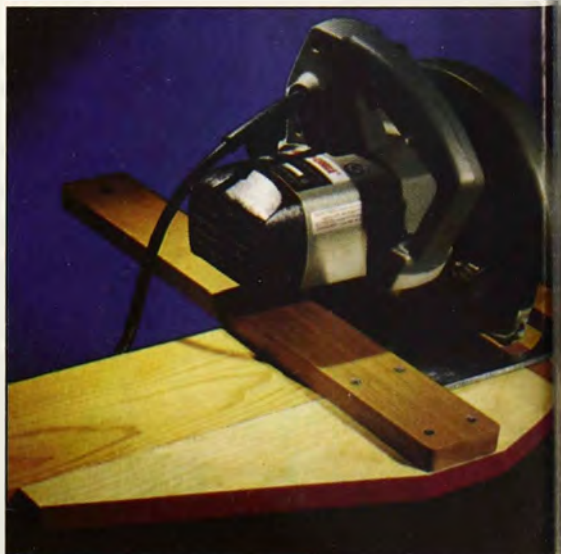
Még a keskenyebb léceket is pontosan szabhatjuk méretre e m készítette fűrészve
